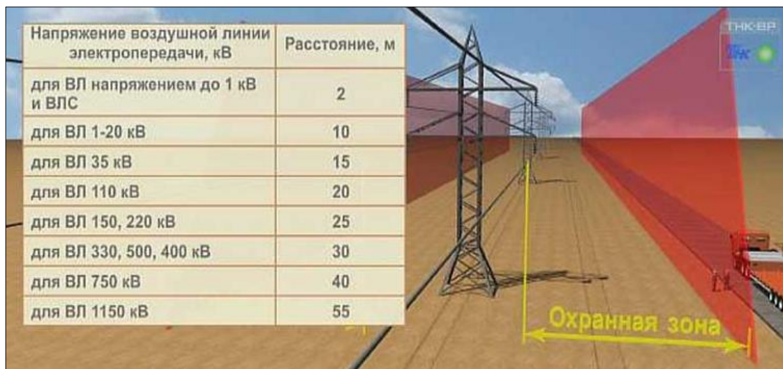
Рисунок 4.1 – Безопасные расстояния нахождения от линий электропередач 5
