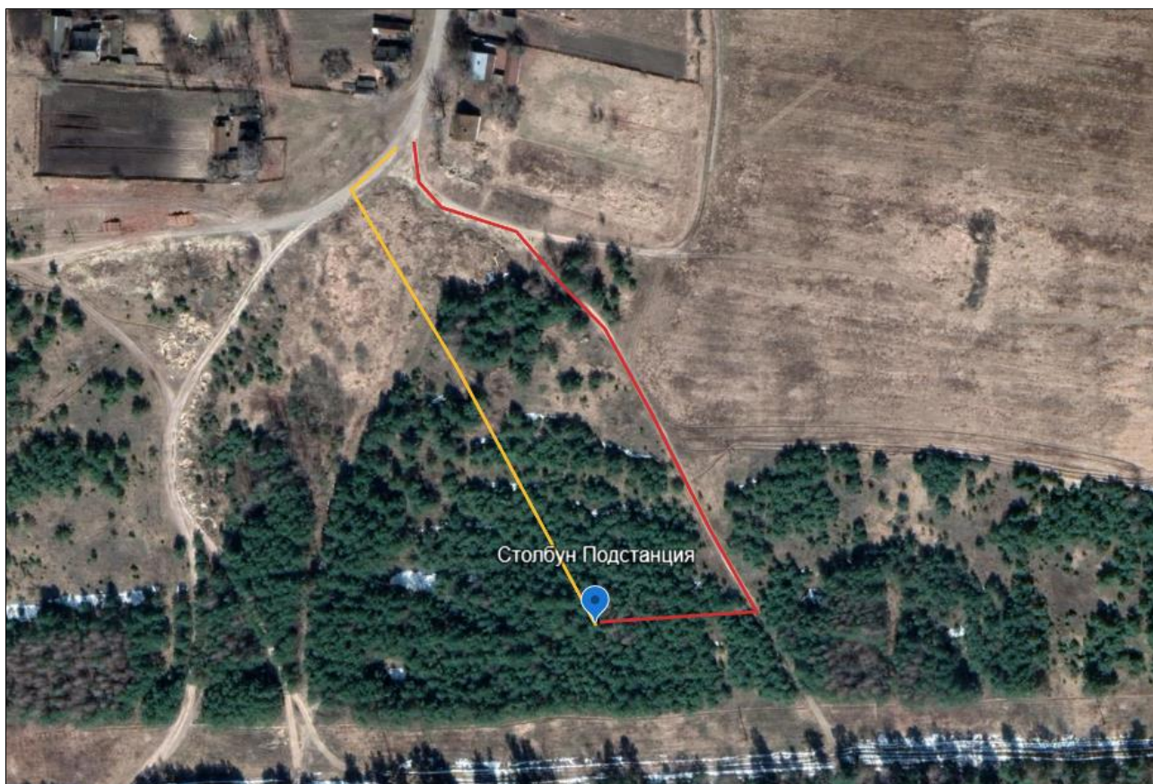
Рисунок 2.1 – Устройство подъезда из асфальтобетона к новой ПС 35/10 кВ «Столбун»: 1 вариант по существующей проселочной дороге ( красный цвет ); 2 вариант по наиболее короткому отрезку ( желтый цвет )
